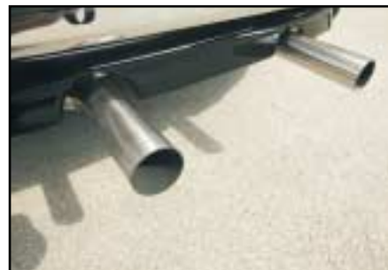
Die GWD-Abgasanlage ist aus Edelstahl gefertigt und lugt in Serienoptik unter'm Heck hervor
